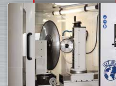
AC 800 Schleifung von Rundmesser bis Durchmesser 800 mm
