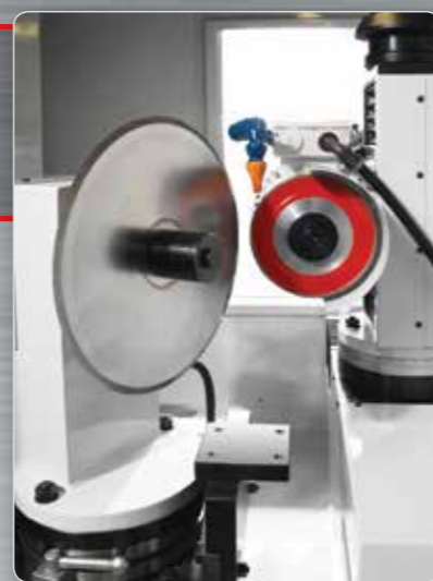
Affilatura con mola tangenziale Peripherie-Schleifscheibe
