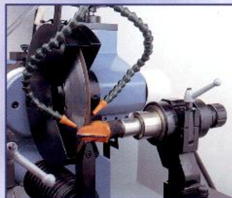
Profilatura punte da pantografo Routerbit profiling Affutage des meches de défonceuse Profilierung von Profilschaftfräsers
